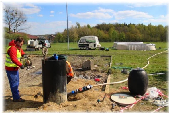
Obr. 6 a 7: Příprava spojená s prováděním intenzivního nálevového testu
