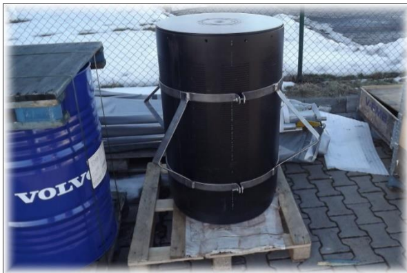
Obr. 2 a 3: Použití centrátorů na plastové zárubnici typu PEHD
