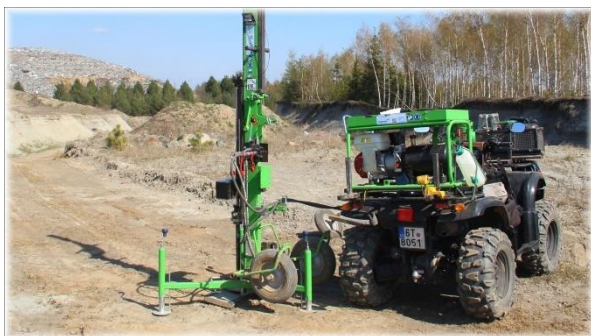
Obr. 9 a 10: Upravená souprava těžké dynamické penetrace a detailní pohled na její aplikaci s jádrovkou
