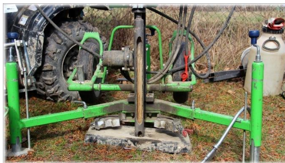
Obr. 9 a 10: Upravená souprava těžké dynamické penetrace a detailní pohled na její aplikaci s jádrovkou
