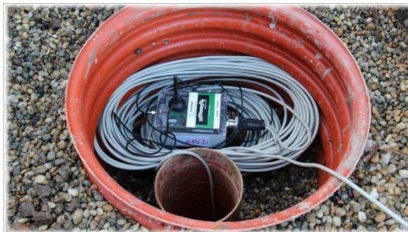
Obr. 13 a 14: Pohled na datalogery a jejich napojení na vysílací stanici
