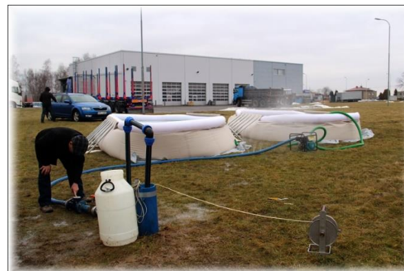
Obr. 6 a 7: Příprava spojená s prováděním intenzivního nálevového testu
