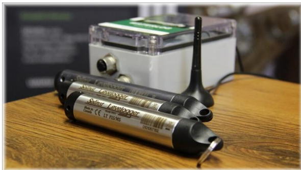
Obr. 13 a 14: Pohled na datalogery a jejich napojení na vysílací stanici
